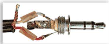
Надеваем защитные трубки на провода и припаиваем их к соответствующим контактам Джека.
