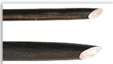
Теперь нужно, при всё ещё включённом паяльнике, несколько раз пройтись напильником по рабочей поверхности жала, чтобы удалить окисел. Сразу же после этого нужно погрузить жало в канифоль, растереть жалом шарик припоя и снова погрузить в канифоль.
