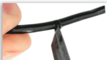
Удерживая одной рукой паяльник, другой рукой проверните экранированный провод вокруг своей оси, прижимая при этом изоляцию к острой грани жала паяльника.
