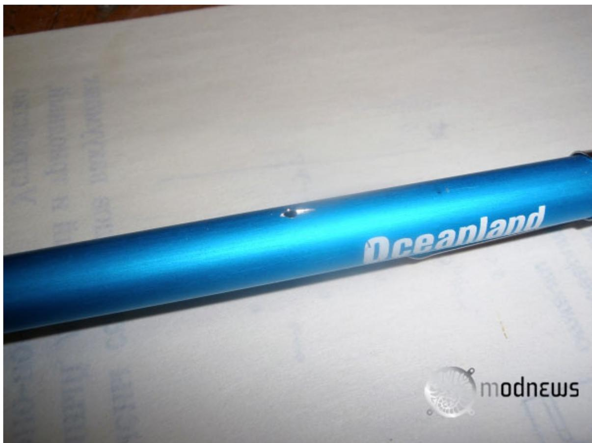
Напильником или ножом проделываем прорезь во внутренней части карандаша. Делаем это с запасом, т.к. эта часть перемещается туда-сюда.
