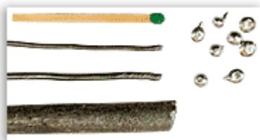
Припой для пайки разъемов подойдет любой, кроме, разве что, легкоплавких припоев вроде сплавов Розе или Вуда.
