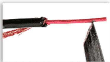
Точно также удаляем изоляцию и с отдельных проводов.
