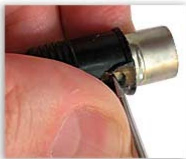
Для разборки штекера ОНЦ-ВГ нужно надавить отвёрткой на лапку и удалить защитный колпачок.
