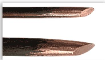
Жало 40-ваттного паяльника диаметром 6 мм, для удобства использования, можно слегка заузить напильником.
