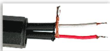
Провод образованный скрученными жилами экрана следует укоротить во избежание его замыкания на левый канал.
