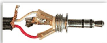
Сдвигаем защитные трубки на контакты разъёма.
