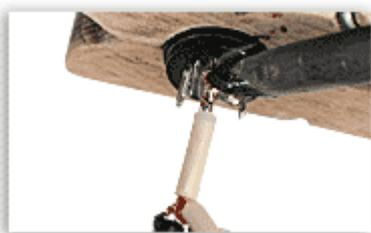
Поочерёдно припаиваем три провода к контактам разъёма.
