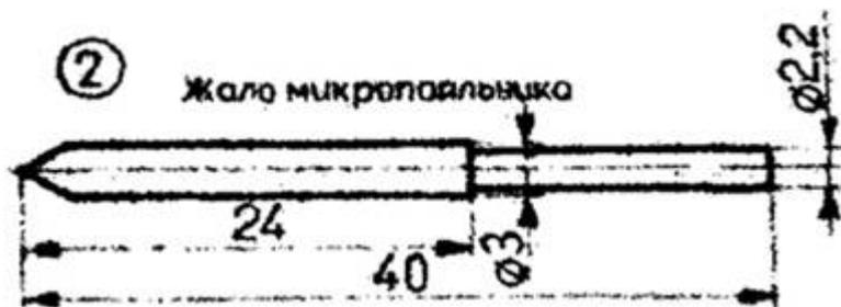
Жало паяльника (рис. 2) можно изготовить из толстой медной проволоки. Конец жала вставляют в отверстие в корпусе резистора. Во избежание замыкания выводов резистора через жало конец его должен быть на 1...1.5 мм короче резистора.
