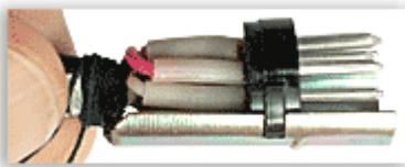
Если кабель достаточно толстый, а именно такие кабели предпочтительны при длине соединения в несколько метров, то для надёжного крепления кабеля нужно плотно намотать 10-12 витков нити в указанное на картинке место.
